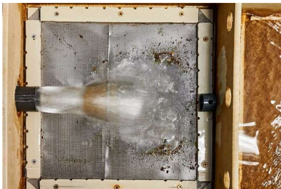
Slika 2. Dvostruku mehaničku filtraciju čine mrežica i spužva
